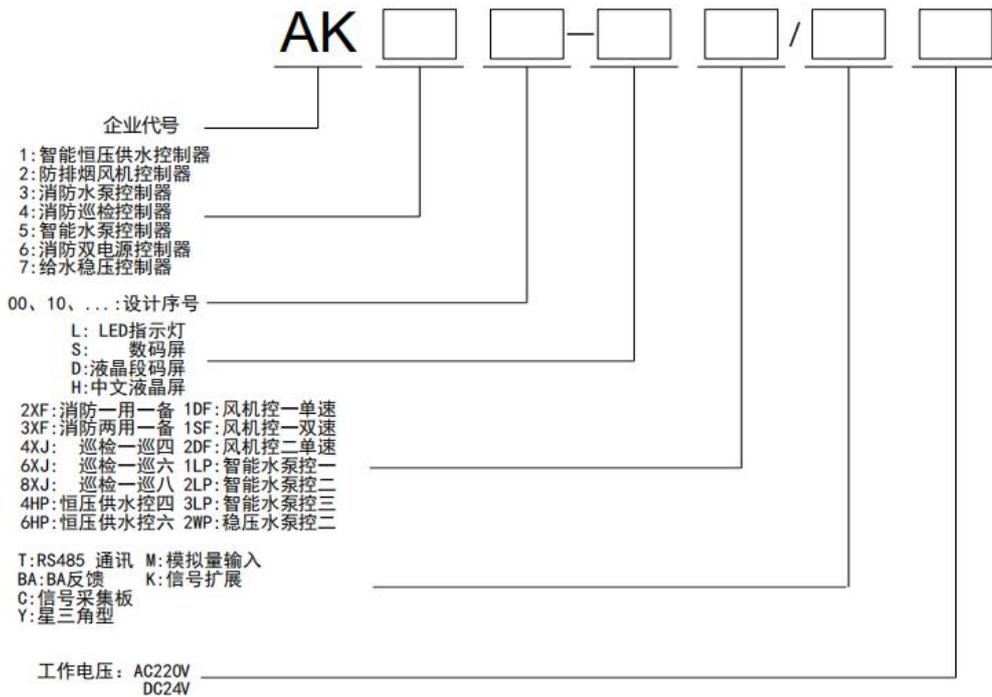
订货完整型号：AK100-C6HP 150-240VAC（智能恒压供水控制器）
