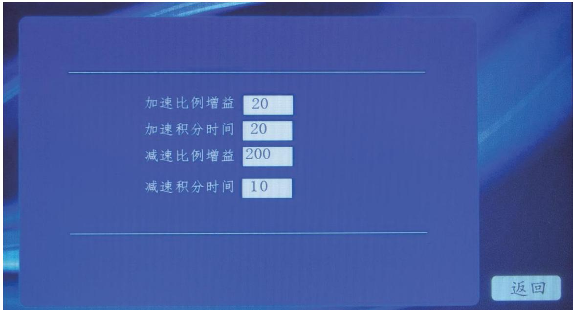
1. 进入系统设置后，点击 PID 菜单，进入 PID 参数设置界面；
