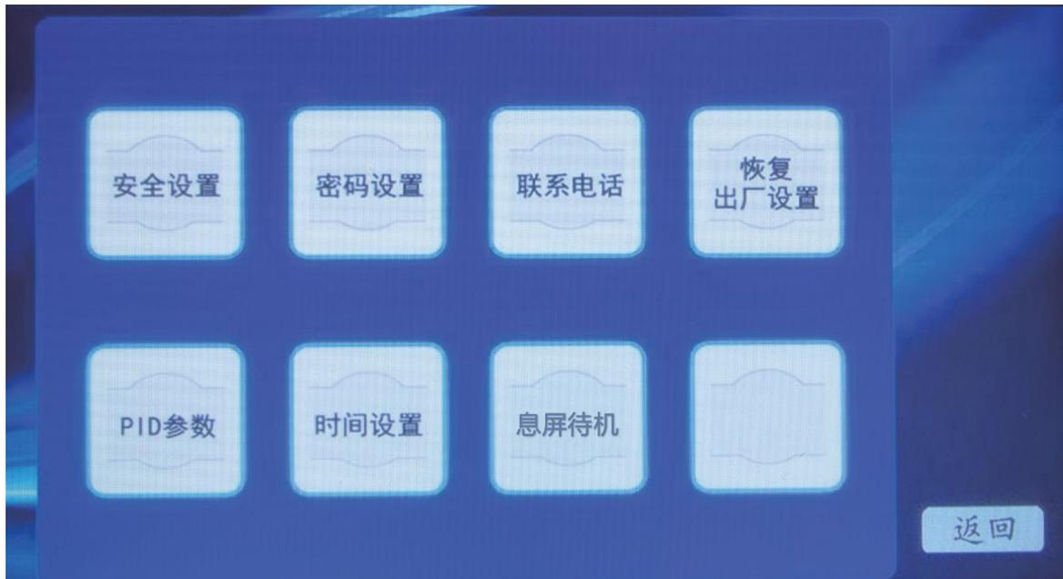
1. 安全设置：禁用手动操作：启用后，主界面上“手动操作”按钮将无法启用；（确保误操作）
